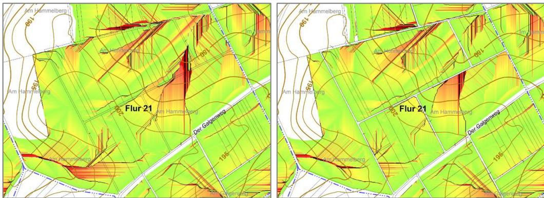
Abbildung 7: Einfluss von Wegebeseitigungen auf das Abflussverhalten des Oberflächenwassers: links alte Bewirtschaftungsstruktur, rechts nach Beseitigung verschiedener Wege, Farbverlauf von hellgrün nach dunkelrot zeigt eine Zunahme der Abflussakkumulation.
