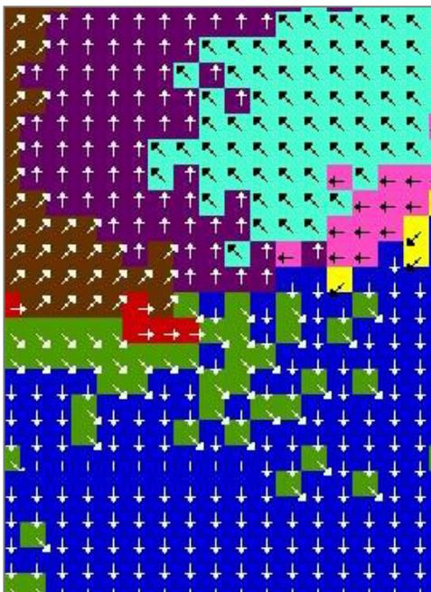
Abbildung 3: Beispielhafte Darstellung der Abflussrichtung auf Grundlage des DGM 1 mittels Auswertung mit dem Werkzeug „Abflussrichtung“ (Grundlage: Miehsler, 2015).
